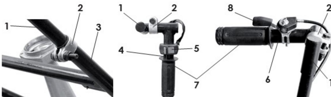
Рис. 2 - Установка стоек с рукоятками управления
